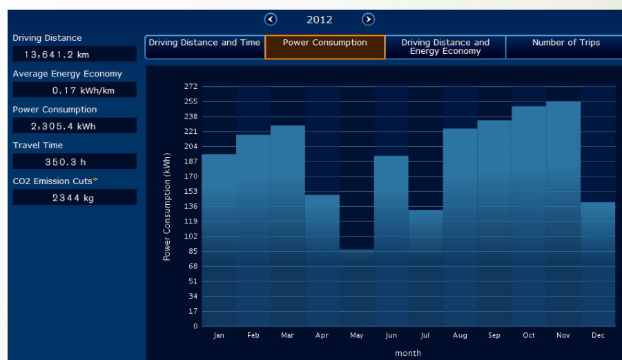
Figur 2. Faktisk månedlig strømforbruk for en elbilist med Nissan LEAF. Totalt 2305,4 kWh forbruk med kjørelengde på 13.641,2 km over et år.
